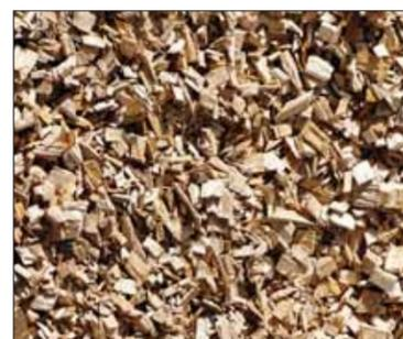
Verwendet werden grobe Hackschnitzel mit einem Wassergehalt von 20 bis 50%. Übergrößen werden vor der Einschleusung gekappt.
