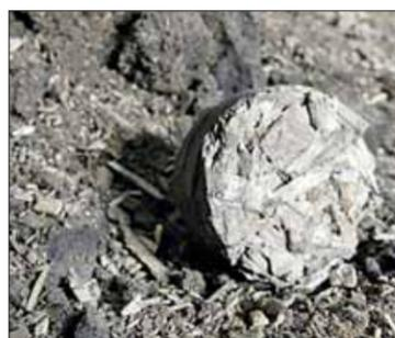
Feinanteile werden im Fördersystem ausgesiebt, getrocknet, brikettiert und anschließend gemeinsam mit den Hackschnitzeln im Vergaser genutzt.
