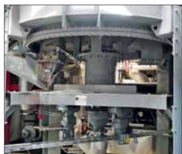
Im unteren Bereich befindet sich der Drehrost, über den die Asche ausgetragen wird. Hier wird auch die angefeuchtete Luft eingeblasen.
